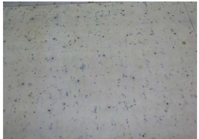
**15** Ausschnitt einer Xface-Platte aus dem Deckenbereich der Tunnelschalung nach 59 Betoniereinsätzen. Trotz einer Vielzahl von Nagellöchern ist die Oberfläche noch gut für weitere Betoniereinsätze geeignet
