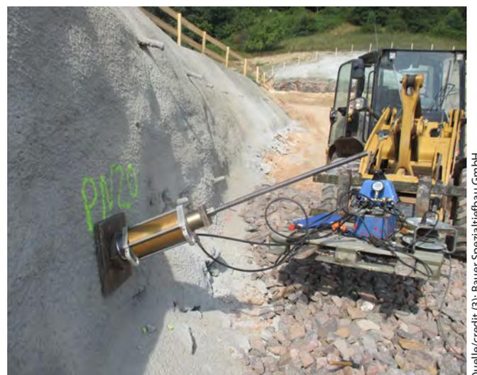
6 Zugversuch zur Bodennagelprüfung im Bereich Tunnel Hain
