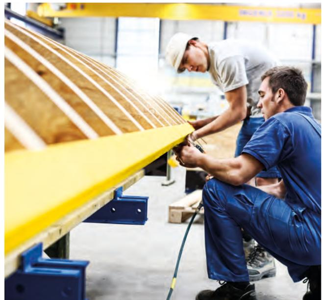
4 Die Montage von Schalungsteilen im Werk ermöglicht Einsparungen und stellt eine höhere Qualität sicher
