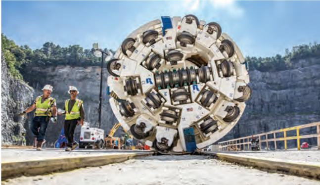
Die Main Beam TBM (Durchmesser: 3,8 m) wird den 8,0 km langen Tunnel durch Granit bohren, mit Bereichen potentiellen Wasserzutritts
