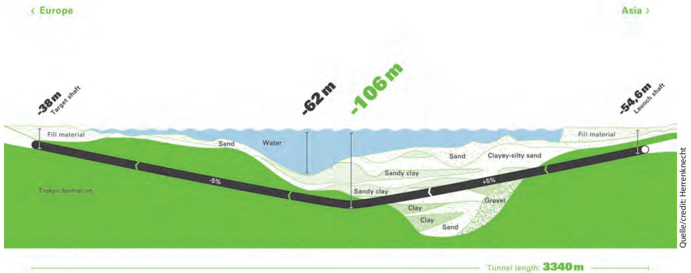
Schematischer Längsschnitt des Eurasia-Tunnels Schematic longitudinal section of the Eurasia Tunnel
