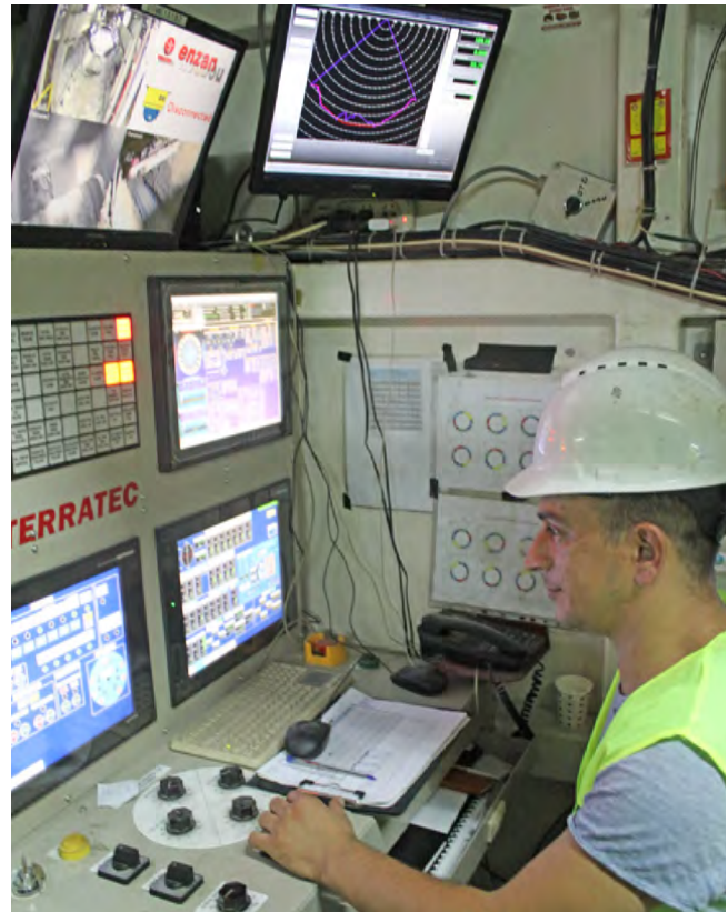
In der Steuerzentrale der Terratec EPB-TBM, mit der zwei jeweils 3 km lange, parallele Tunnelstrecken gebohrt werden
