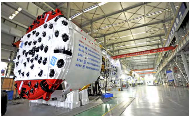
Im August erfolgte die Abnahme der ersten von CREG hergestellten Gripper-TBM am Wasserversorgungstunnel Jilin-Yinsong in China
