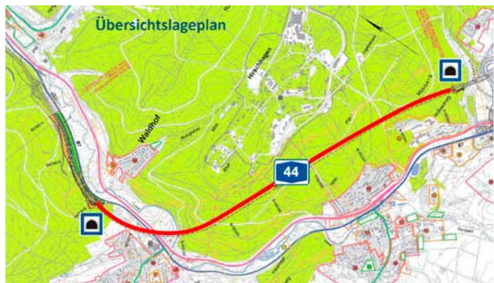
Mit dem Bau des 4,2 km langen Hirschhagentunnels wurde Anfang Juni 2013 begonnen; die Fertigstellung des dann zweitlängsten Straßentunnels Deutschlands ist für 2018 geplant
