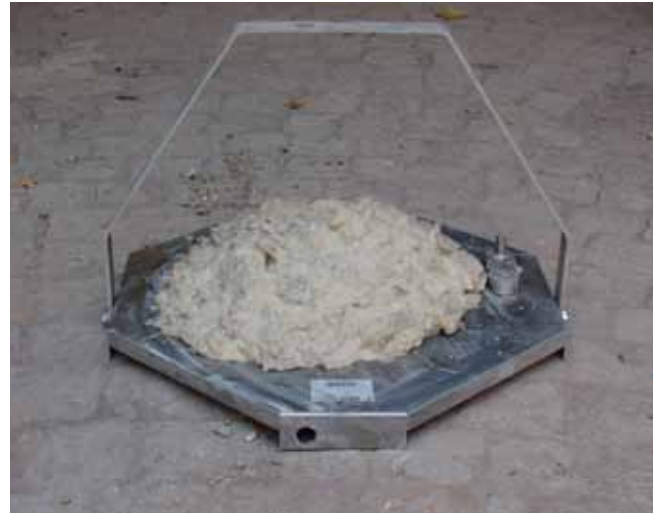
Exakte Labortests desselben Materials (hier bei einem „Slumpstest“) halfen den Tunnelbauern bei der Entwicklung effektiver Bodenkonditionierungen
