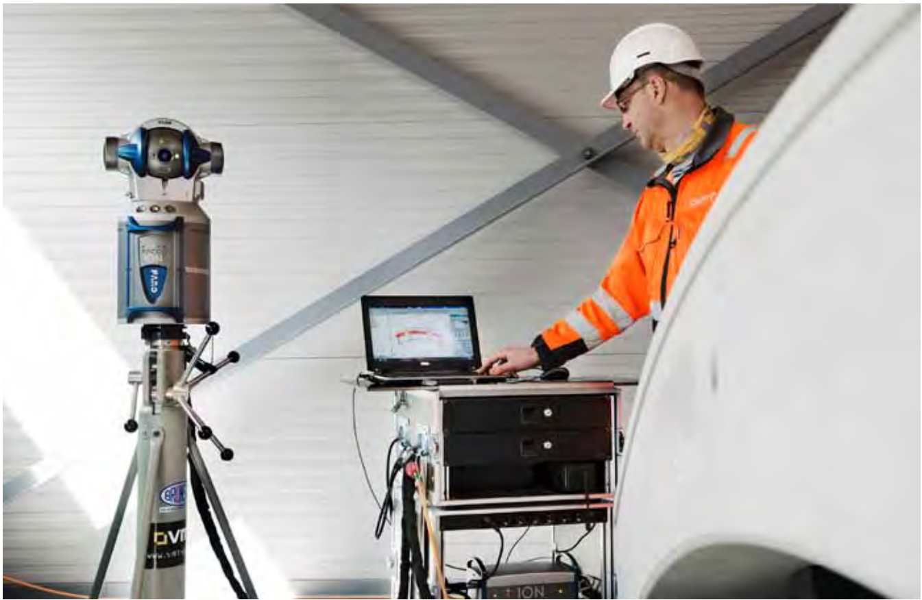
Kontrollvermessung mit 3D-Laser-Tracker Control measurement with 3D laser tracker
