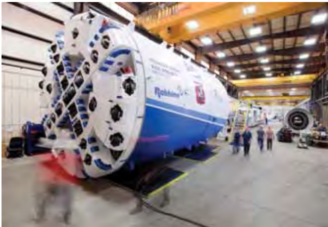
Drei neue Erddruck-Tunnelbohrmaschinen und eine aufbereitete TBM wurden eigens für die gemischten Moskauer Bodenverhältnisse ausgerüstet, die von feinem Sand bis zu steifem Ton und Findlingen reichen
