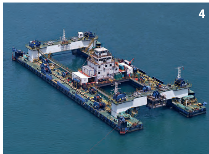
Schwimmkran beim Ablassen eines Fertigteils Floating crane lowering a precast element
