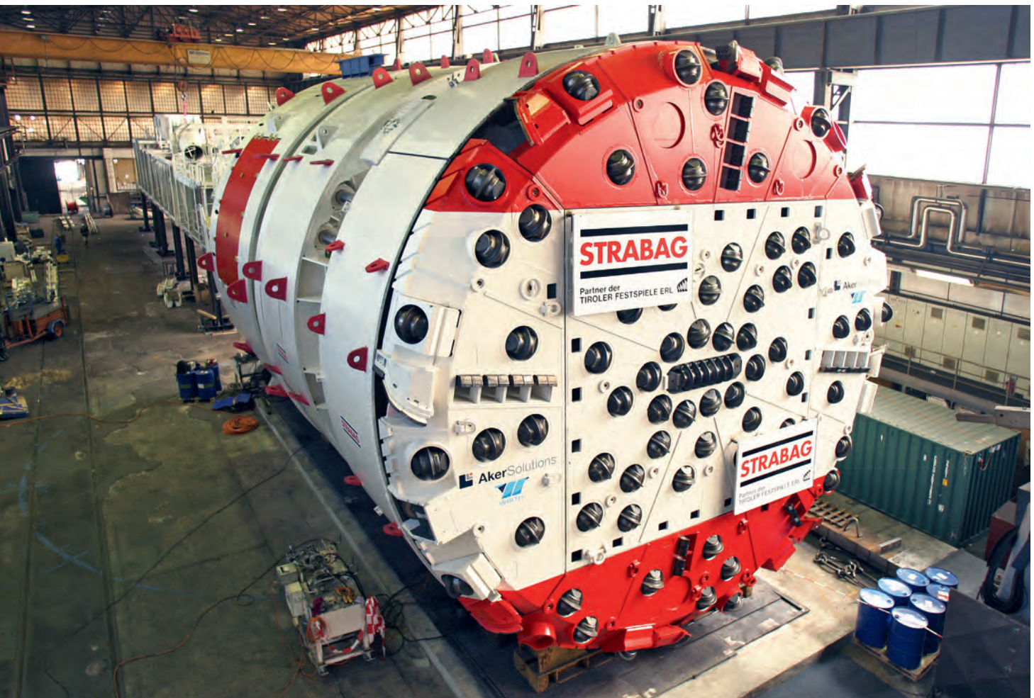
80 Einzelmeißel im Bohrkopf sorgen für einen Vortrieb von 25 bis 30 m pro Tag. Gewartet wird der gigantische Bohrkopf mit Werkzeugen von Hyltorc. 80 individual bits in the cutterhead cater for a 25 to 30 m per day rate of advance. Hyltorc tools are used to service the gigantic cutterhead.
