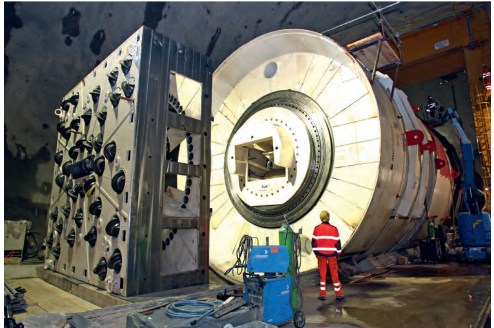
Gigantisches Gerät: Der Tunnelbohrer ist 180 m lang. Allein Der Bohrkopf wiegt 100 t.
