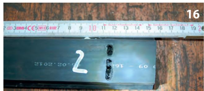
Dichtband 2. Die Eintrittsstelle der Bohrung oben im Band ist nicht sichtbar.
