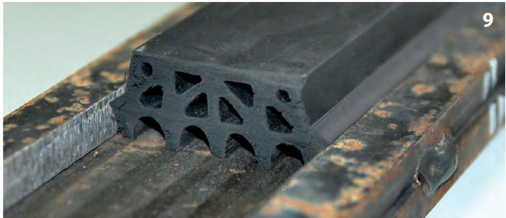
Für den Werkstattversuch angefertigtes Stahlbauteil mit aufgelegtem Dichtband
