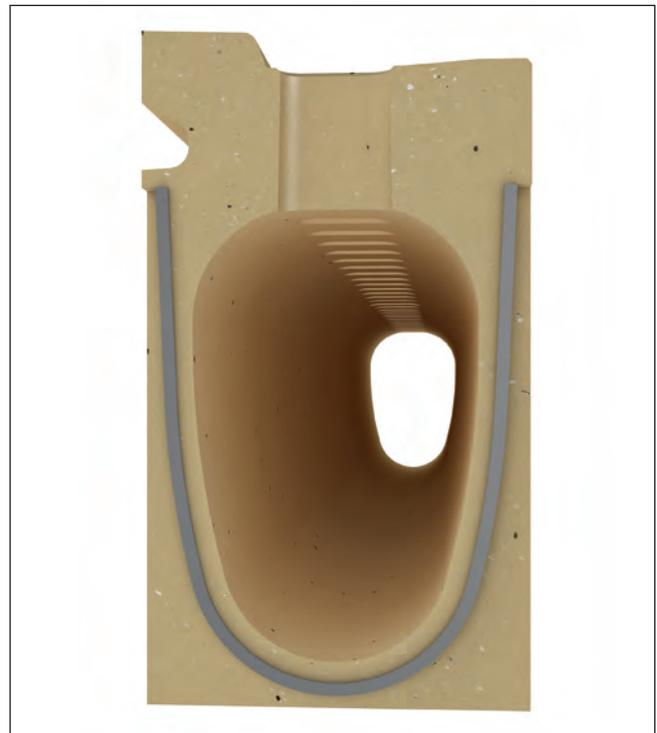
Das Verlegekonzept von oben bedeutet eine Erhöhung der Verlegeleistung. Die neue Seitenwandstruktur und die Materialverteilung führen zu einer erhöhten Tragfähigkeit und Gesamtstabilität. Hinterschnittene Taschen dienen der verbesserten Verankerung zur angrenzenden Betonverfüllung im Notwegbereich
