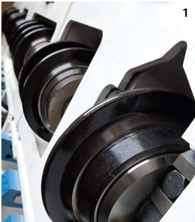
Die neuen Druckausgleichsringe an den Schneidrollen erlauben EPB-Auf-fahrungen bei höheren Wasserdrücken und mit geringerem Ausfallrisiko.
