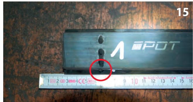
Dichtband 1 mit sichtbarem Austrittsloch unten (rot eingekreist). Mitten im Band der Bohrkanal in der Kontaktfläche. Das gezeigte Band entspricht dem rechten Band in Bild 14.
