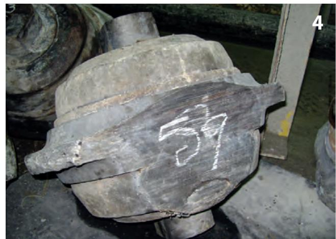
Schneidrollenschaden: Das Schneidrollendesign muss verbessert werden, da sie im Einsatz in weichen Gesteinen zu einseitiger Abnutzung neigen.
