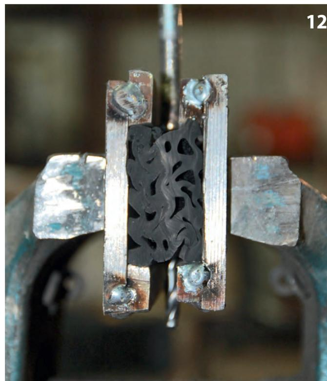
Durchbohren der Tübbingdichtbänder mit einem 5 mm Metallbohrer
