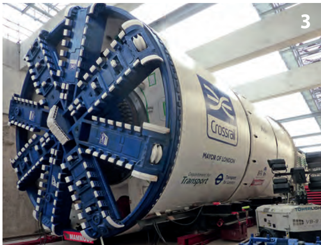
TBM Westbound (S-705) auf dem Weg zur Anfahrwand Westbound TBM (S-705) en route to the start-up wall
