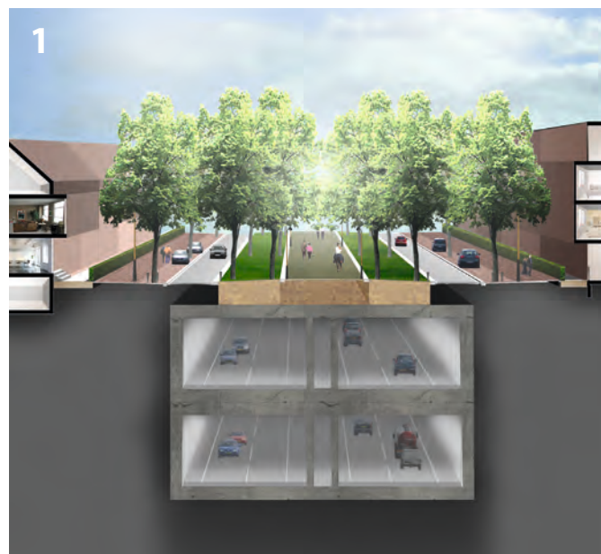
Darstellung des Doppelstocktunnels nach Fertigstellung Presentation of the double-deck tunnel after completion
