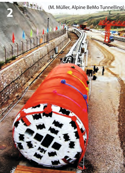
TVM mit 4,88 m Bohrkopfdurchmesser vor dem Start in den Pinglu Tunnel
