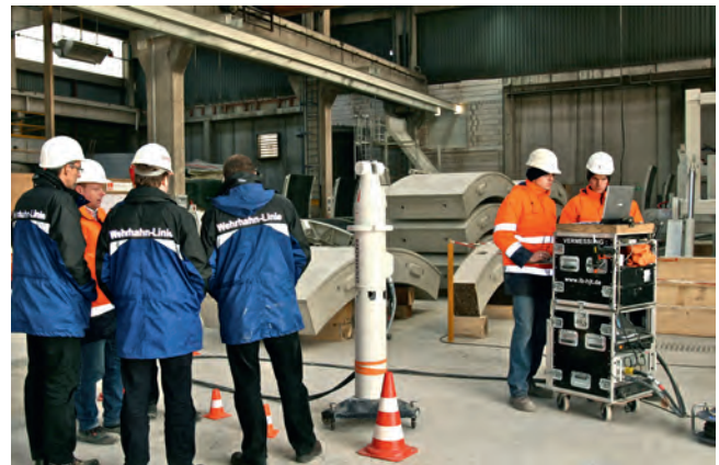
Vermessung der Tübbing-Segmente zur Überprüfung der Einhaltung extrem enger Toleranzvorgaben von zum Teil max. 0,3 mm
