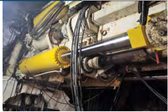
Vorschubzylinder Betrieb: Im Einsatz pressen die 4 Vorschubzylinder den Bohrkopf mit insgesamt 14.300 kN in das Gestein
